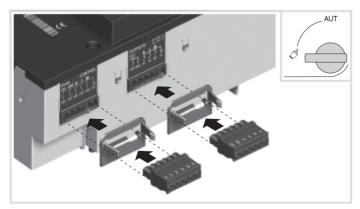
Use cables with 1,5 to 2,5 mm<sup>2</sup> section. Screw M3-Tightening torque: mini: 0,5 Nm - maxi: 0,6 Nm.
